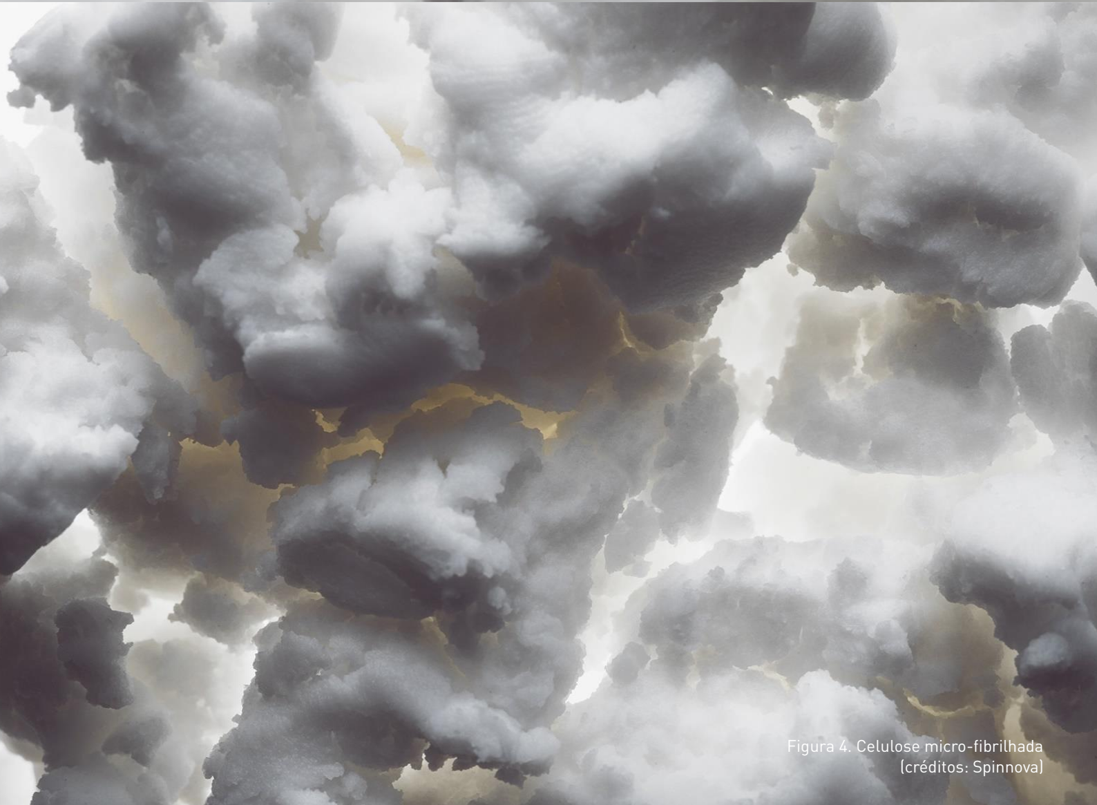
Figura 3. Suspensão de celulose micro-fibrilhada (créditos: Spinnova)
